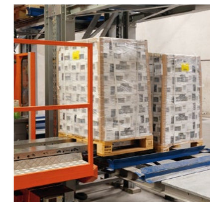
Ein weiteres Beispiel für verbesserte Performance dank cleverer Details: Exaktes, halbautomatisches Handling der immer wichtigeren Halbpaletten.
