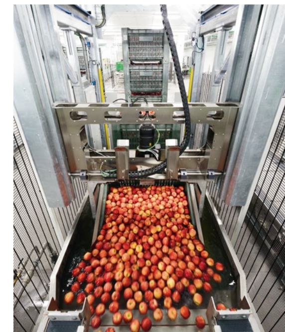
Beste Beleg für die Zufriedenheit des Kunden ist ein Folgeprojekt: 2014 hat LTW für MIVOR 16 vollautomatische Obstentleerstationen in der Vorzone des Verpackungsbereichs installiert.
