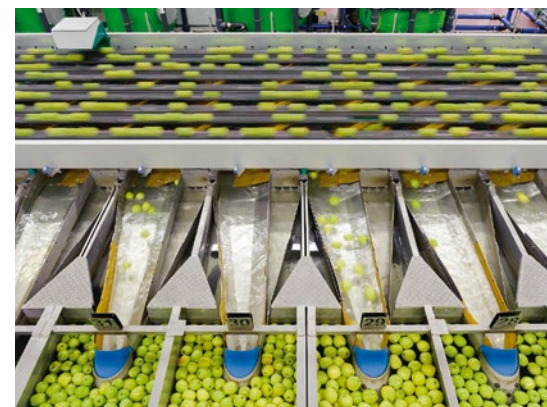
Die neue Sortieranlage klassifiziert bis zu 65 Äpfel pro Sekunde auf Basis eines 3D-Modells, das für jeden einzelnen Apfel aus 60 Fotografien berechnet wird.
