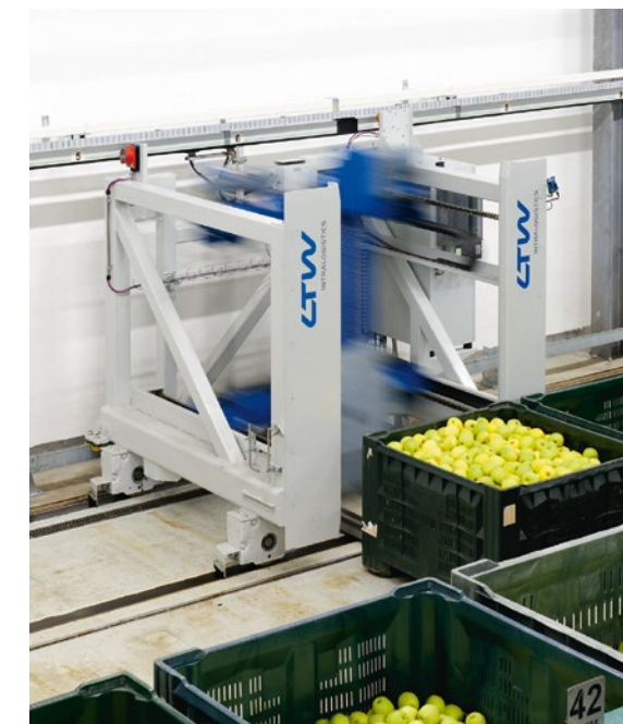
Die zweigeschossige, automatische Förderstrecke zwischen Sortieranlage und Hochregallager mit zwei Verschiebewagen (Bild) und zwei Vertikalförderern.
