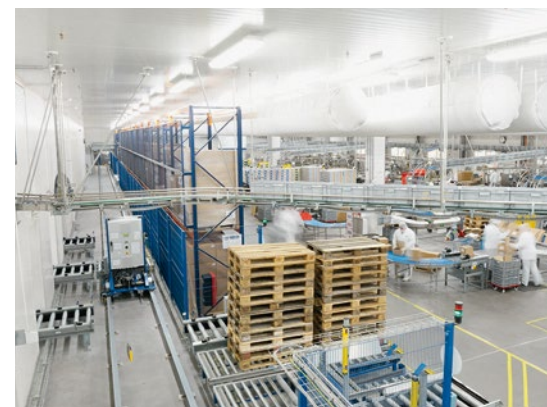
Ein Verschiebewagen verknüpft Produktion und Verpackung (rechts) mit dem Hochregallager (links) und unterstützt das Leerpaletten-Handling.
