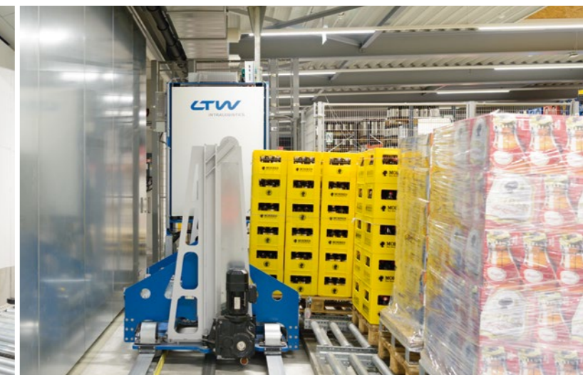
Ein Vertikalförderer (links) verbindet den Warenein- und -ausgang im Erdgeschoss, die Kommissionierung im Obergeschoss und den Keller für Weine, 3.000-Liter-Biertanks und andere langsam drehende Artikel. An der Schnittstelle zur Kommissionierzone dockt der Verschiebewagen (rechts) dank Hub- und Neigevorrichtung perfekt an die Schwerkraftrollenbahnen an. Vertikalförderer und Verschiebewagen sind wie die Regalbediengeräte mit der patentierten LTW-Riementechnik ausgestattet.
