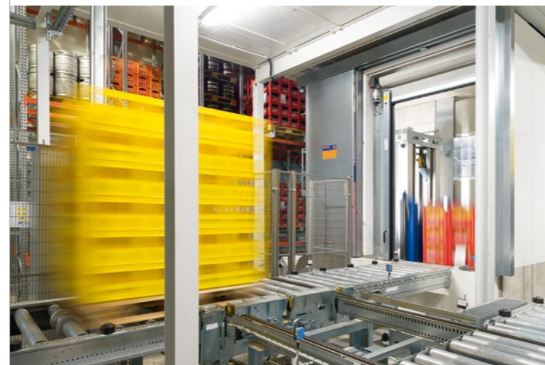
Ein Vertikalförderer (links) verbindet den Warenein- und -ausgang im Erdgeschoss, die Kommissionierung im Obergeschoss und den Keller für Weine, 3.000-Liter-Biertanks und andere langsam drehende Artikel. An der Schnittstelle zur Kommissionierzone dockt der Verschiebewagen (rechts) dank Hub- und Neigevorrichtung perfekt an die Schwerkraftrollenbahnen an. Vertikalförderer und Verschiebewagen sind wie die Regalbediengeräte mit der patentierten LTW-Riementechnik ausgestattet.
