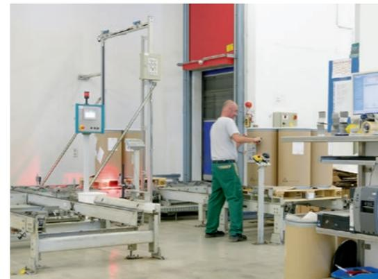
Vorzone des Hochregallagers mit I-Punkt (Identifikationspunkt). Im Rahmen des Retrofits wird die Anlagenkommunikation von Interbus auf Profinet umgestellt.
